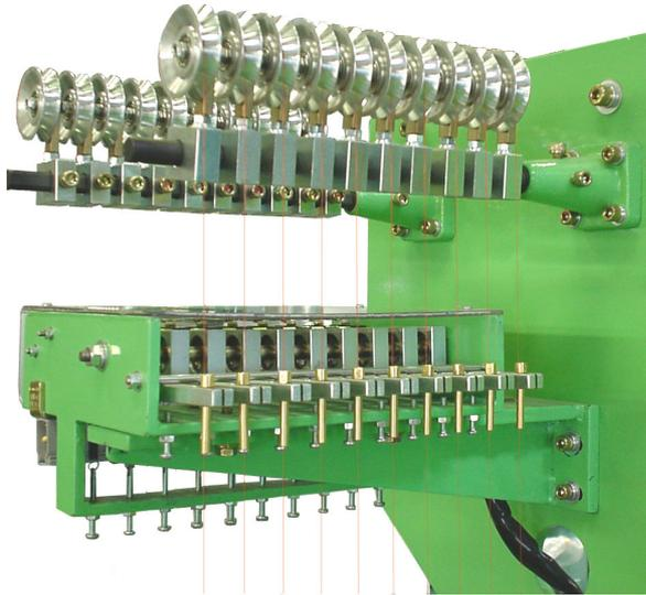
【皮膜泡检测器探测磁头装置】
